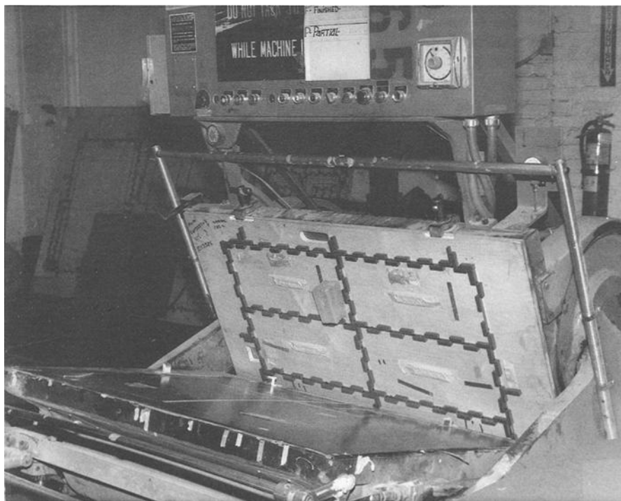
FIG. 5—A flat platen die cutter.
